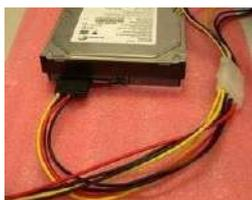
步骤 3: 将 SATA 电源线 15-针脚接口(黑色)一端接到 SATA 硬盘。
